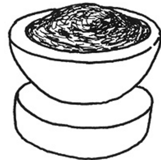
ヤニ台 鉄の器にヤニが盛ってある。アクセサリーをここに押しつけて固定し、細かい加工を行う。
